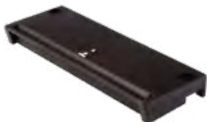
Ein Falzlüfter, der im inneren Teil des Rahmens platziert wird, so dass er bei geschlossenem Fenster fast unsichtbar ist. Durch den Einbau besteht die Möglichkeit eines Luftstroms an der Stelle, an der er sich befindet. Luftströmung (für zwei Lüfter) bei 10 Pa:  $5 \text{ m}^3/\text{h}$ . Schalldämmung:  $D_{n,e,w} = 34 \text{ dB}$ .
