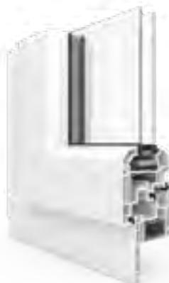
Ein Profil, das den Fenstereinbau in bestehenden Gebäuden ermöglicht, ohne dass die alten Holzrahmen entfernt werden müssen. Die Flosse verdeckt den alten Rahmen im Inneren des Gebäudes, während spezielle Zusatzprofile ihn außen verdecken.
