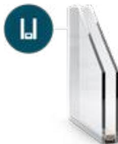
2-Fach Verglasung, besteht aus zwei Glasscheiben. Dies ist Standard für einfache Fenster- und Türsysteme. In dem Raum zwischen den vom Abstandshalter erzeugten Scheiben befindet sich hauptsächlich Argon (90%), was den Wärmeübergangskoeffizienten  $U_g$  weiter verringert.
