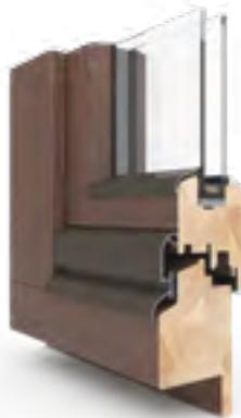
Profilversion, die den Einbau neuer Fenster in bestehenden Gebäuden ermöglicht, ohne dass alte Holzrahmen entfernt werden müssen. Es sind verschiedene Längen der Flosse erhältlich, die den alten Rahmen im Inneren des Gebäudes abdeckt.
