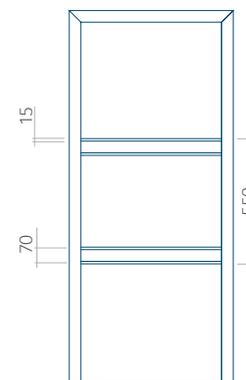
Die Platte ist in einer Version mit einer schmaleren Nut (6 mm) erhältlich, in der es keine INOX-Anwendung gibt – Plattenmuster 110, während dieses Muster in der Holzplatte eine 4 mm Nut hat.
